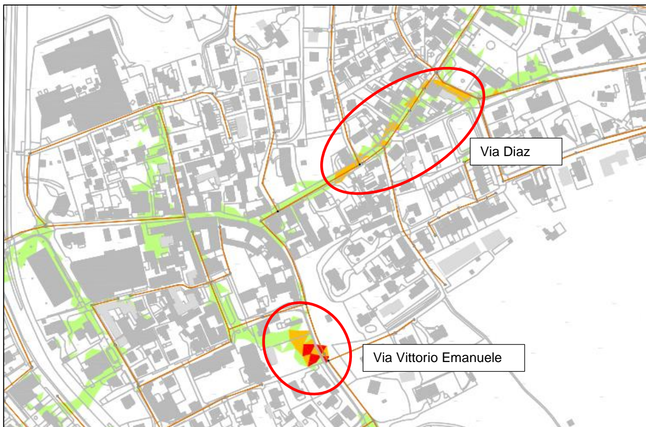
Figura 51: Aree con criticità idraulica dovute alla fognatura T50 in Via Diaz e Via Vittorio Emanuele
