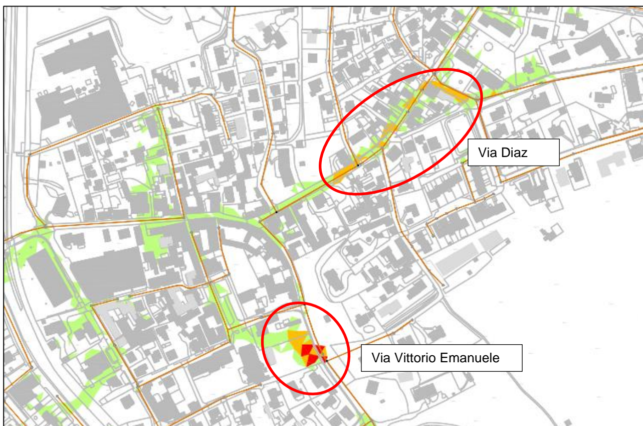
Figura 3: Aree con criticità idraulica dovute alla fognatura T50 in Via Diaz e Via Vittorio Emanuele
