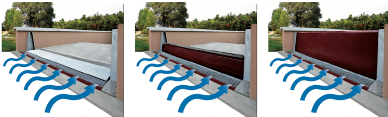
Figura 6: esempio di sistema di paratoia autoposizionante (tratto da sistema DIGALL - www.digall.it )
