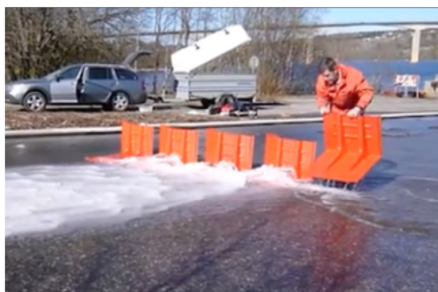
Figura 9: esempio di elementi componibili in grado di contrastare la spinta dell'acqua ( http://noaq.com/en/products/ )
